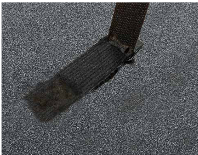
Nakketugevuse katse rebimistesti abil
