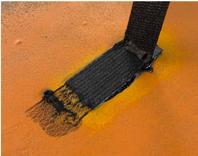
Nakketugevuse katse rebimistesti abil
