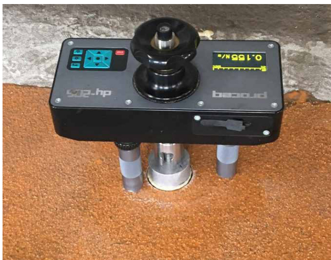
Pinnatugevuse ja nakke kontrollimine
