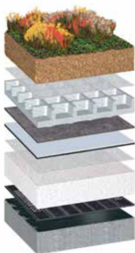
Haljaskatus Kaitsekiht FSM 600 BauderTHERMOFOL U Eralduskiht GV 120 EPS-soojustus
